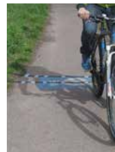
Radzählanlagen zur Er- fassung des Ist-Zustandes
