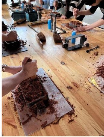
Dann verdichtet mit dem Stampfholz. Abziehen mit dem Abziehenisen.
